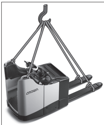
Fig. 45 Løfte en truck med platform med bagindgang med en kran
