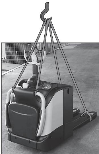
Fig. 44 Løfte en truck med foldbar platform med en kran
