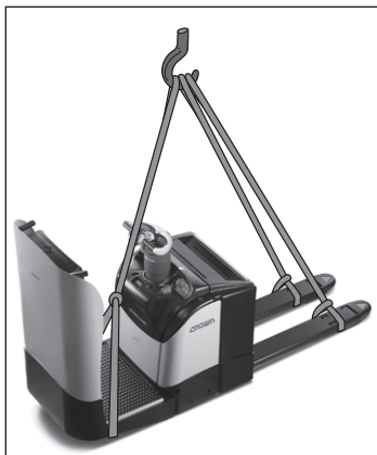
Fig. 46 Løfte en truck med platform med sideindgang med en kran
