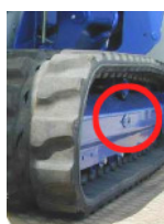
Fig. 66 Bolten for strammerullen er placeret her.
