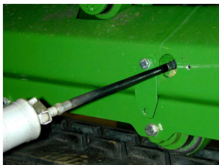
Fig. 67 Smørepistol for smørenippel på strammerullen.
