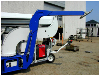
Fig. 12 Støtteben drejet væk fra liften
