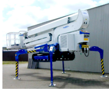
Fig. 58 Liften løftet ved hjælp af støttebenene
