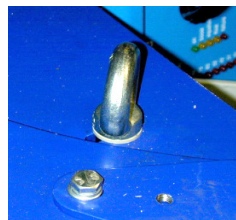
Fig. 9 Låsebolt sænket/støtteben låst
