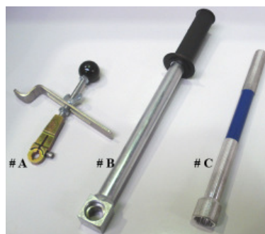
Fig. 35a Nødsænkingsudstyr, bag dæksel #3 fig. 35c
