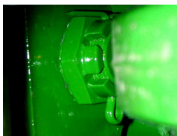
Fig. 68 Bolt – Bælte ikke strammet.
