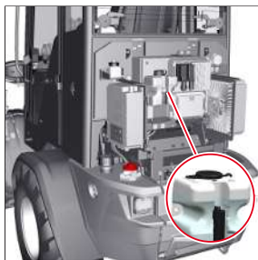
Ill. 186: Placering af sprinklervæskebeholder
