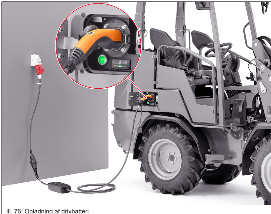
III. 76: Opladning af drivbatteri
