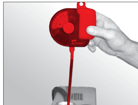
Fig. 111 Kontrol af frostbeskyttelsesblanding
