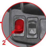
Fig. 46 Åbning af hydraulisk lås til ophængte redskaber
