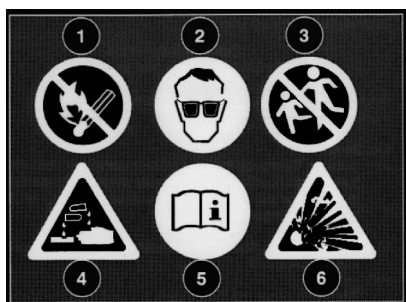
Advarselsmærkat på batteri
