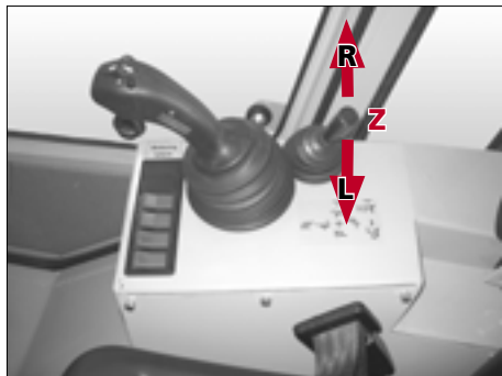
Fig. - 37 Styrehåndtag til ekstra hydraulik
