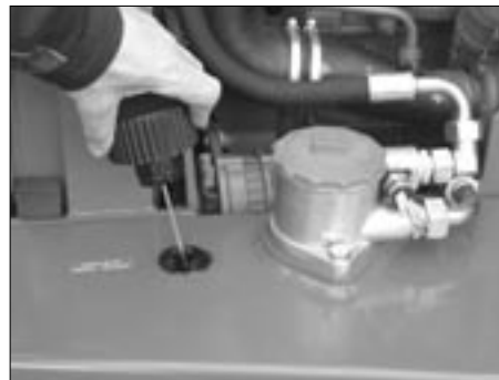
Fig. - 65 Reducering af resttrykket
