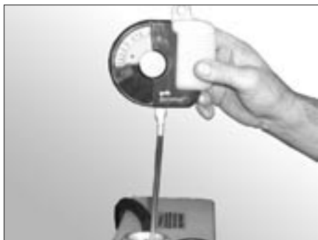
Fig. - 83 Kontrol af frost- beskyttelsesblan- dning
