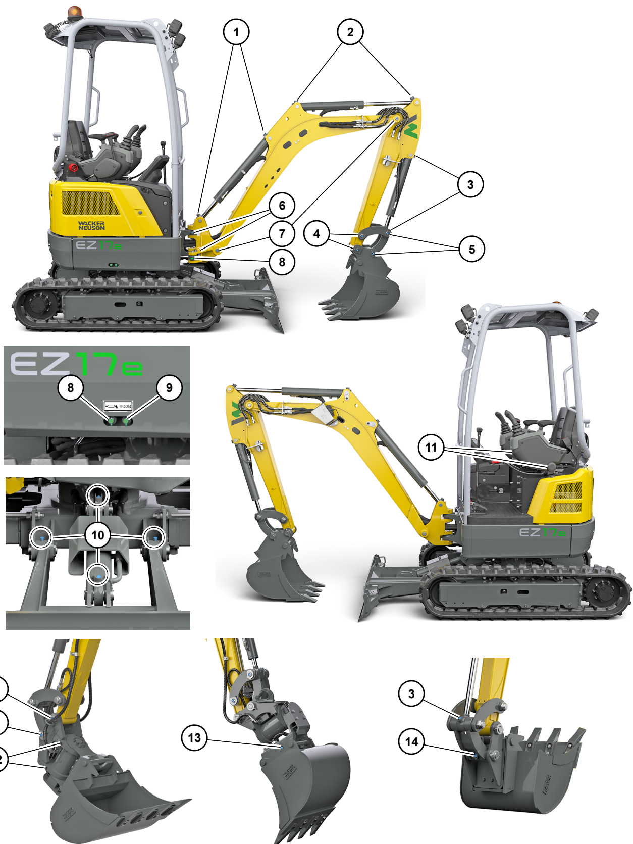
Fig. 221 Smøresteder inkl. Powertilt og det hydrauliske hurtigskiftesystem Easy Lock
