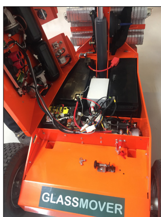
Figur 16 For at komme til vakuumfitrene tages vakuumlåget af liften (se afsnit 7.1)
