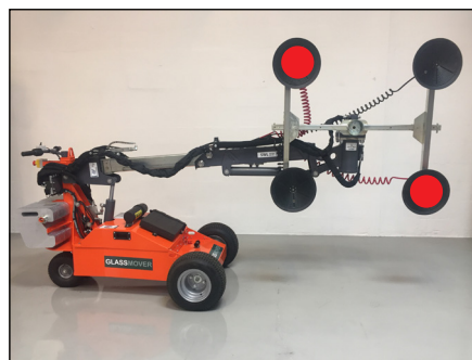
Figur 10 Sugekopperne monteres med rød slange øverst i den ene side og sort slange øverst i den anden side.
