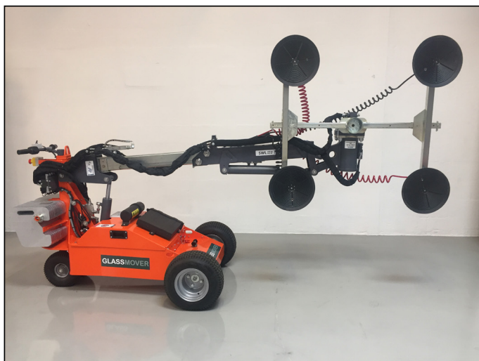
Figur 8 Centervange drejet ud til sidehængt last og roteret 45 grader.
