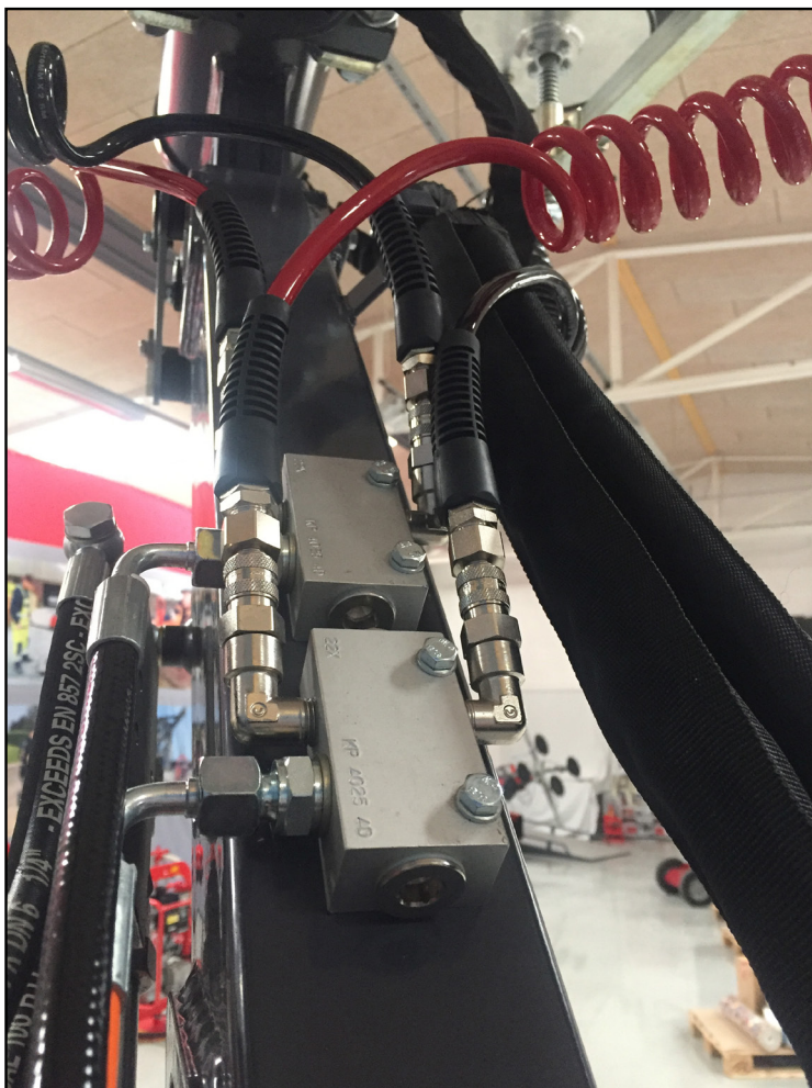
Figur 13 Slangerne fra sugekopperne tilsluttes lynkoblingerne. De to røde slanger monteres venstre side af fordelerblokkene. En i hver blok.
