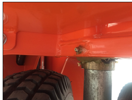
Figur 19 Lige over det styrende hjul findes nederste smørenippel. Der skal afmonteres en skærm for smøring kan foretages
