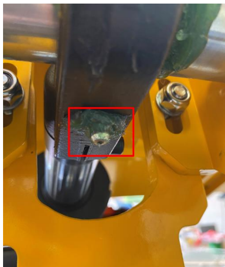
Figur 75: Smørenippel under container ved rotationslås
