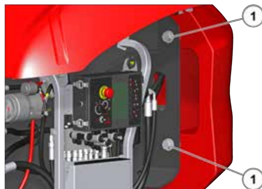
Figur 207: Kontrol af kontravægtens tilspænding 1 - 180 ATJE S1 - 180 ATJE RC S1
