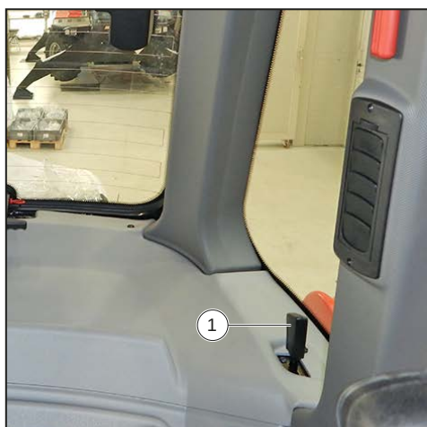
Figur 60: Udløserarm til dørvindue inde fra kabinen
