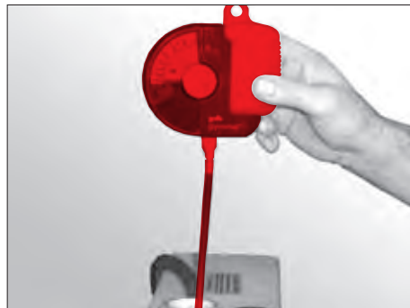
Fig. 86 Kontrol af frostbeskyttelsesblanding
