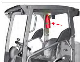
III. 3: Monteringssted til brandslukkeren
