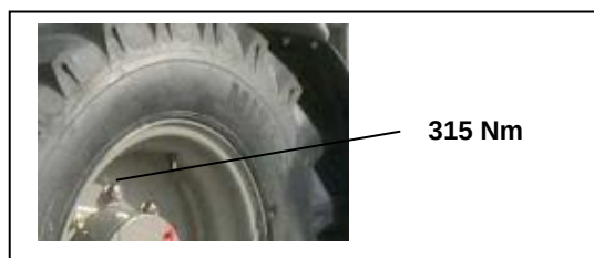
Fig. 91 Spænd hjulmøtrikkerne
