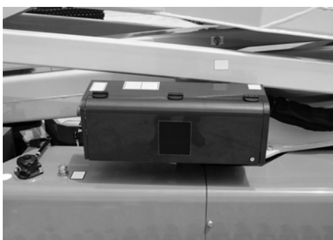
Fig. 127 Plade til luftdelens fordele
