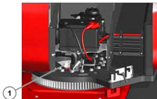
Figur 166: Smøring af ringgearsenhed 1
