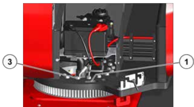
Figur 202: Kontrol af ringgearenhedens tilspænding 1
