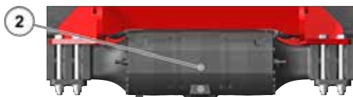
Figur 150: Kontrol af bagakslens differentiale for lækager
