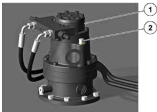
Figur 168: Kontrol af oliestanden i motoren til drejeskivens rotation 1
