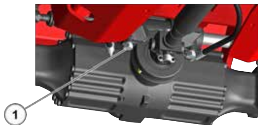
Figur 159: Kontrol af akslernes tilspænding 2
