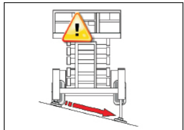
Figur 8.13 - Maskine på skråning
