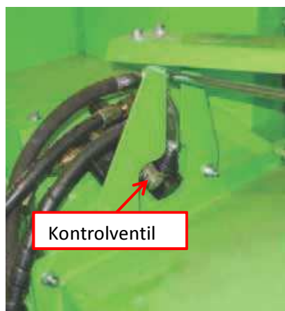
Fig. 5.4 Kontrolknop for justerbar indtræksvalse
