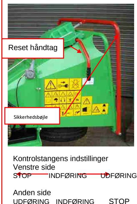
Fig. 3.4.1 Kontrolstang og nulstillingsarm
