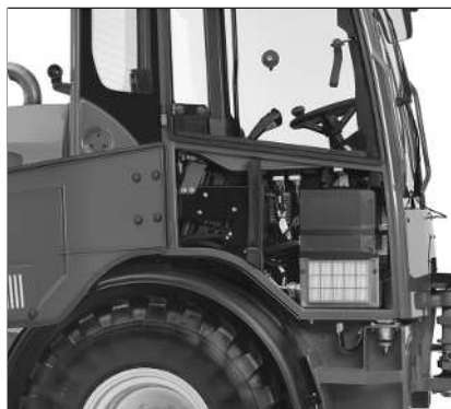
III. 172: Vedligeholdelsesklap i højre sidedør
