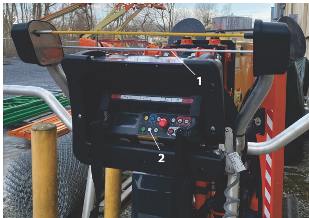
Figur 4-7. SkyGuard™-sensor og tilsidesættelseskontaktens placering
