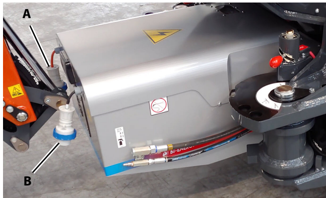
A. Opladning af lithium-ion-batteri
