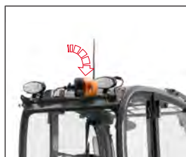
III. 82: Nedklapning af roterende advarselsblink
