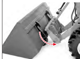
III. 111: Frakobling med mekanisk lås
