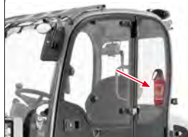
III. 3: Monteringssted til brandslukkeren
