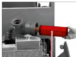
III. 187: Afmontering af hovedfilter
