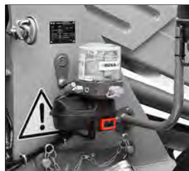
III. 175: Positionering af det centrale smøresystem, på køretøjet
