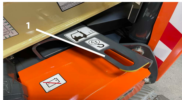
Figur 4-5. Løftemaskine - Løfteøjer placering
