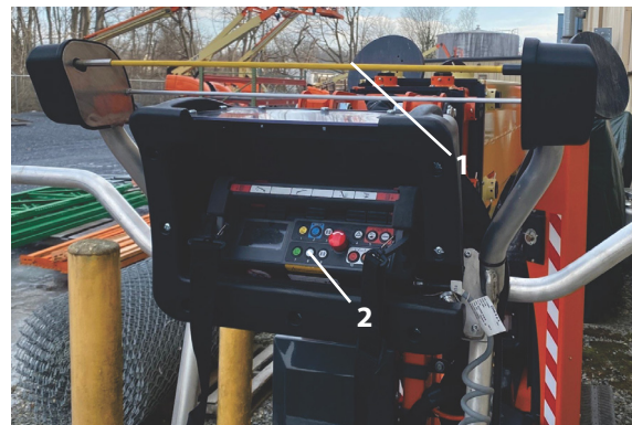
Figur 4-4. Placering af SkyGuard™-sensor og tilsidesættelseskontakt
