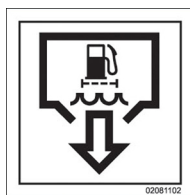
Nedsænkning vandsump brændstoffilter
